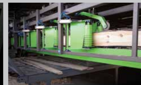
Авт. разгрузка с отделением досок и отходов
