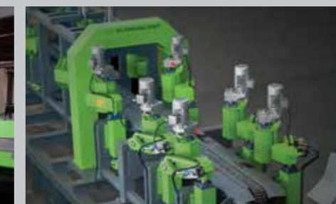
Сканирование бревен с оптимизацией
