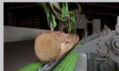
Подача с роликами для поворота бревна
