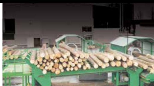
Склад бревен с металлодетектором
