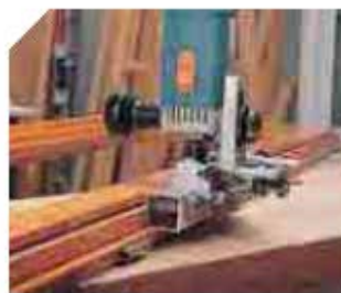
Прорезка паза на окне со стороны петель.
