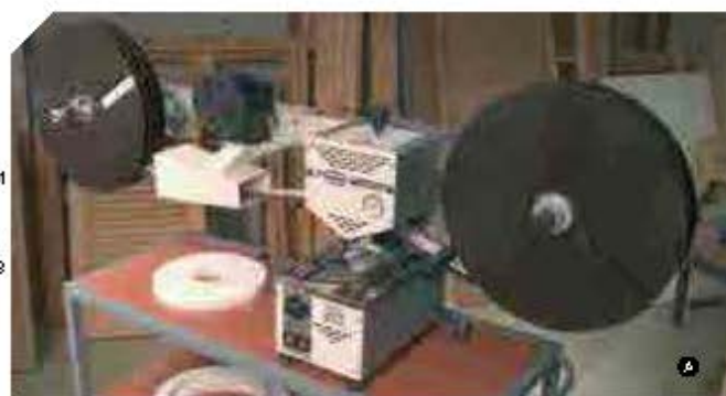
Станок позволяет наносить клей на полосы ламината, пластика или древесины, без использования станка.
