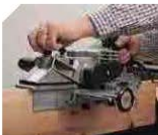
Упор регулируемый для снятия фаски под разными углами.
