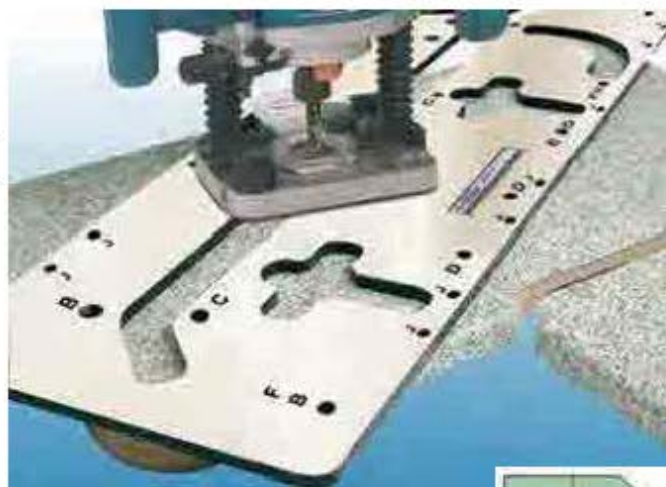
Фрезерование крестообразного паза под стяжку.
