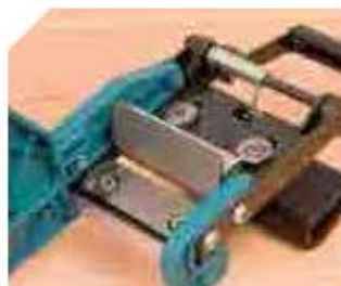
Система подрезки кромки двумя ножами.
