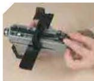
Микрометрическая регулировка ширины реза.
