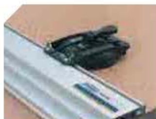
Шина направляющая может крепиться при помощи вакуумных присосок (присоски используются на гладких непористых поверхностях).
