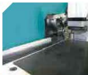
Упор со стороны обрабатываемого кромочного материала.
