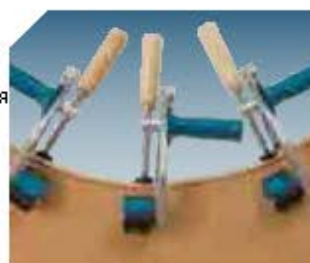
Фиксирование торцевых накладок на вогнутых панелях.
