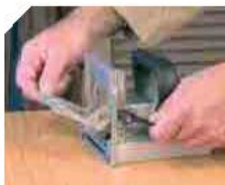
Угол и высота регулируется по встроенным шкалам.
