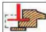
Прорезка паза на окне со стороны замка.
