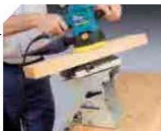
Регулируемое наклонно-поворотное основание.
