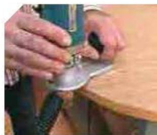
Насадка CA56G позволяет за один проход фрезеровать все четыре стороны панели по пласти. Имеет большую опорную поверхность и дополнительную ручку для большей стабильности в работе. Применяется для обработки криволинейных деталей, как вогнутых, так и выпуклых.
