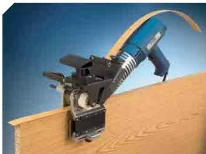
Для облицовки панелей кромочным материалом с предварительно нанесенным клеевым слоем толщиной до 2 мм и шириной до 25 мм с высокой точностью и стабильностью.
