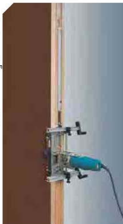
Формирование посадочного места под 2ю, 3ю и 4ю петлю не требует перенастройки инструмента.
