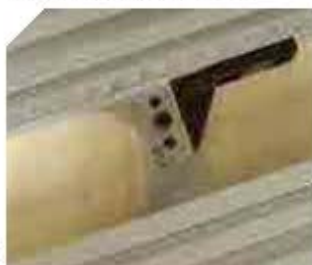
Комплектуется с специальным упором для получения прямого угла в видимых зонах стыковки проступи и подступенка.
