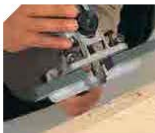
Установка петель с насадкой ZB93.
