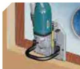
Алмазный диск для работы по строительным материалам позволяет вырезать раму целиком. При этой операции инструмент базируется основанием на раме.
