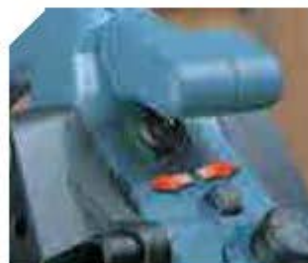
Переключатель направление выброса стружки.
